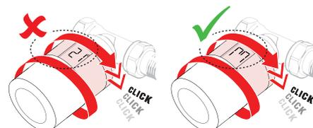
3. Halten Sie den Knopf für 3 Sekunden gedrückt. Der Heizkörperthermostat Danfoss Ally™ ist nun montiert und zeigt die aktuelle Temperatur an.
