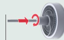
Kabel durchziehen, Standrohr aufschrauben
