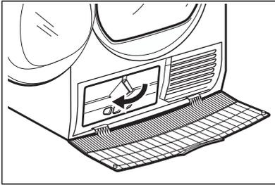
4. Nehmen Sie das Rohr an der linken Wand des Fachs. Öffnen Sie die Kappe, um das Wasser abzulassen.
