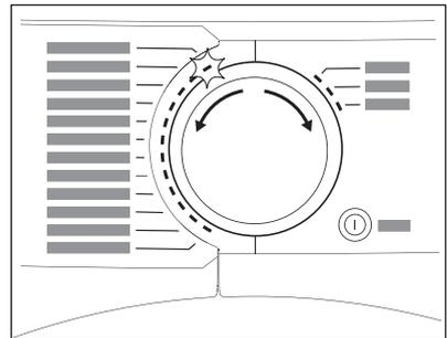
Wählen Sie das gewünschte Programm mit dem Programmwahlschalter aus. Das Display zeigt die ungefähre Programmdauer an.
