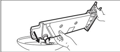
3. Drücken Sie die Kunststoffverbindung wieder ein und setzen Sie den Wasserbehälter wieder in das Gerät.
