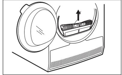
2. Öffnen Sie die Kondensatorabdeckung.
