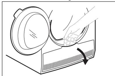
3. Drehen Sie den Hebel, um den Kondensatordeckel zu entriegeln und senken Sie den Kondensatordeckel ab.
