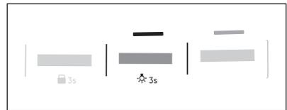
Halten Sie die **Dampf** Taste etwa 3 Sekunden lang gedrückt. Das Licht in der Trommel leuchtet.
