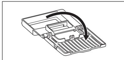
4. Reinigen Sie den Filter mit der feuchten Hand.
