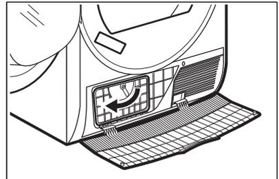
4. Klappen Sie den Kondensatordeckel nach unten.
