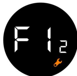
Schrauben Sie den Thermostaten im Uhrzeigersinn auf das Ventil des Radiatoren von Hand auf (max 5Nm). Drücken Sie das Display erneut, es erscheint F1\_2 .
