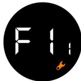
Appuyez sur l'écran pendant environ 3 secondes; F1 1 apparaît à l'écran (L'appareil est en mode installation, vibre légèrement.)
