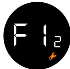
Vissez le thermostat à la main dans le sens des aiguilles d'une montre sur la vanne du radiateur (max 5Nm). Appuyez à nouveau sur l'écran, F1 2 apparaît à l'écran.
