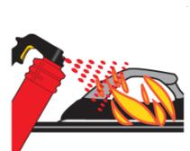
... für elektrische Geräte bis 1000 V anwendbar, Mindestabstand 1 m
