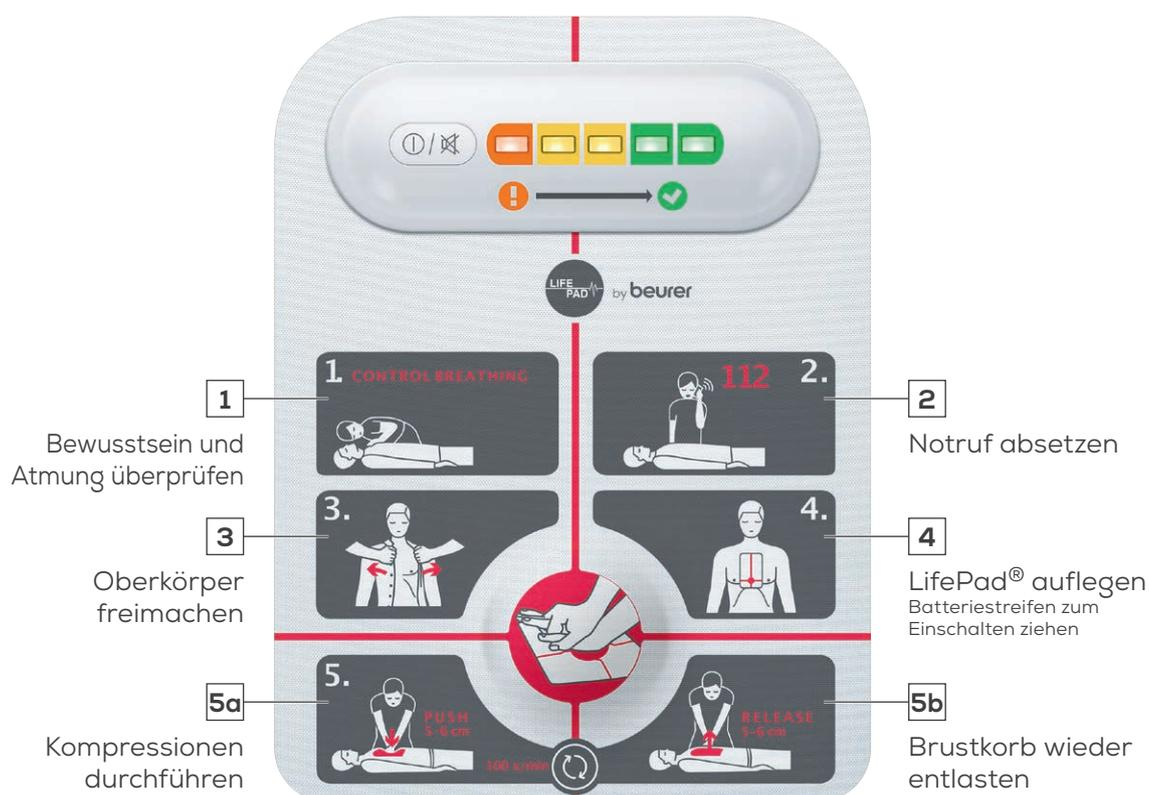
Schritt **5a** und **5b** im Rhythmus des Signaltons wiederholen, um eine Frequenz von 100 Kompressionen pro Minute zu gewährleisten (Ton = Drücken).
