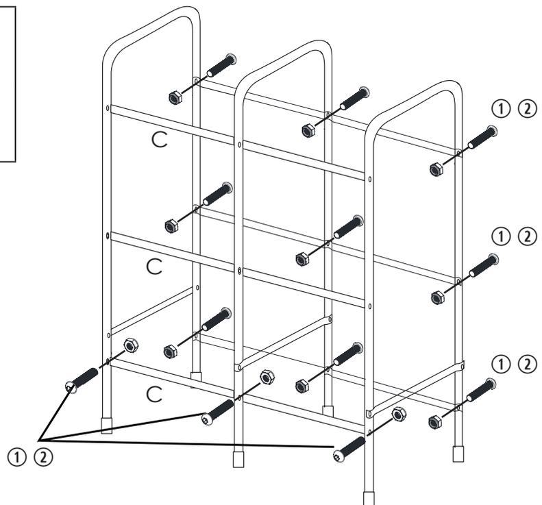
③ Verbinden Sie mit den Schrauben M6 x 30 mm **[1]** und den Muttern M6 **[2]** die Längsstrebe **[C]** mit den fertigen Elementen aus Schritt ②.
