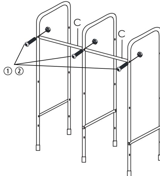
② Verbinden Sie mit den Schrauben M6 x 30 mm **[1]** und den Muttern M6 **[2]** die Längsstrebe **[C]** mit den drei fertigen Elementen aus Schritt ①.
