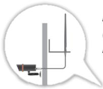
*Für größere Distanzen zwischen Kamera und Router gibt es Antennenkabel und Antennen (als Zubehör erhältlich), die an einer Außenwand montiert werden können, um eine maximale Reichweite zu erreichen.*
