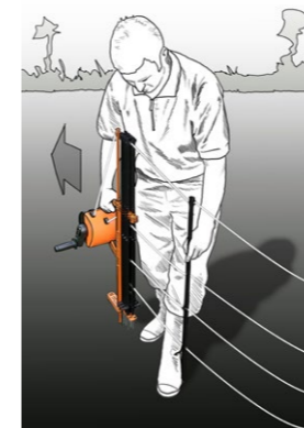
STEG 4 STEG 4a Montera stolpar i marken på önskat avstånd. När en hörnstolpe behövs, använd en staglina för att förankra stolpen rakt (4a).
