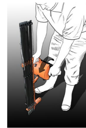
SCHRITT 1 Befestigungsschraube lösen (gegen den Uhrzeigersinn).
