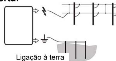
Nas ligações de cerca (5 ou 6), podem ser operados sistemas de cerca independentes entre si. O valor de medição apresentado no visor (1) e as luzes de controlo correspondentes apenas podem apresentar com exatidão a saída com energia máxima (6). Desactive imediatamente a cerca e proceda à requisição imediata de um técnico especializado para o controlo da mesma, antes de a colocar novamente em funcionamento, se a lâmpada de controlo piscar aproximadamente mais que 1x por segundo.
