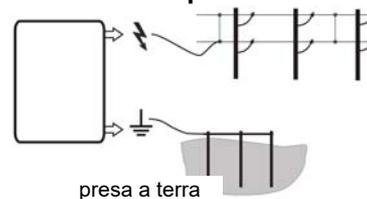
Per ciascun collegamento della recinzione (5 e/o 6), è possibile azionare impianti della recinzione indipendenti l'uno dall'altro. Tuttavia, il valore misurato visualizzato nel display (1) e la relativa spia di controllo possono indicare con precisione esclusivamente l'uscita di energia massima (6). Se la spia luminosa lampeggia più velocemente di circa 1 volta al secondo, disattivare immediatamente lo strumento e far eseguire un controllo da uno specialista prima della riattivazione.
