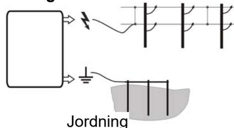
Det går att ansluta och driva av varandra oberoende stängselsystem till stängselanslutningarna (5 eller 6). Mätvärdet som visas på displayen (1) och den tillhörande kontrolllampan kan dock utslutande endast visas exakt för utgången med den maximala energin (6). Om kontrolllampan skulle börja blinka snabbare än ca. 1x per sekund, ska apparaten stängas av genast. Den måste kontrolleras av fackman före återkoppling.
