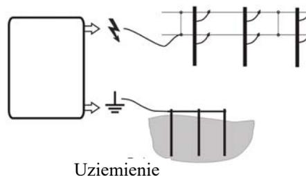
Na przyłączach ogrodzenia (5 lub 6) można eksploatować równocześnie odrębne instalacje ogrodzenia. Wartość pomiarowa wskazywana na wyświetlaczu (1) i odpowiadająca jej lampka kontrolna mogą jednak dokładnie podawać wyłącznie dane dotyczące wyjścia z maksymalną energią (6). Jeśli lampka kontrolna miga szybciej niż 1x na sekundę, należy natychmiast wyłączyć urządzenie i przed ponownym włączeniem zlecić jego sprawdzenie fachowcowi.
