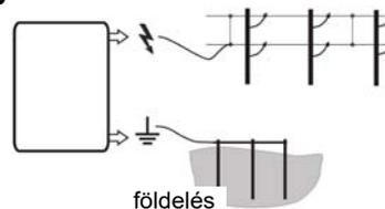
A (5, ill. 6) kerítés-csatlakozókkal egymástól független kerítésrendszerek üzemeltethetők.
