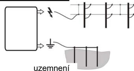
Na přípojkách plotu (5, resp. 6) lze provozovat na sobě nezávislá plotová zařízení.
