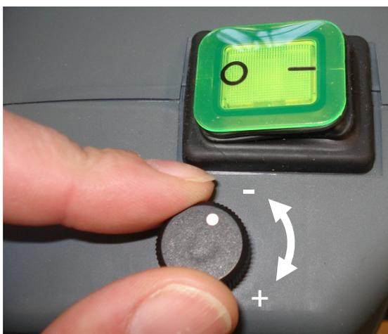
La pompe W 85 H peut être équipée en option d'une commande de régime. La plage de régime se situe entre 9000 et 11000 tr/min (selon la viscosité et le système).
