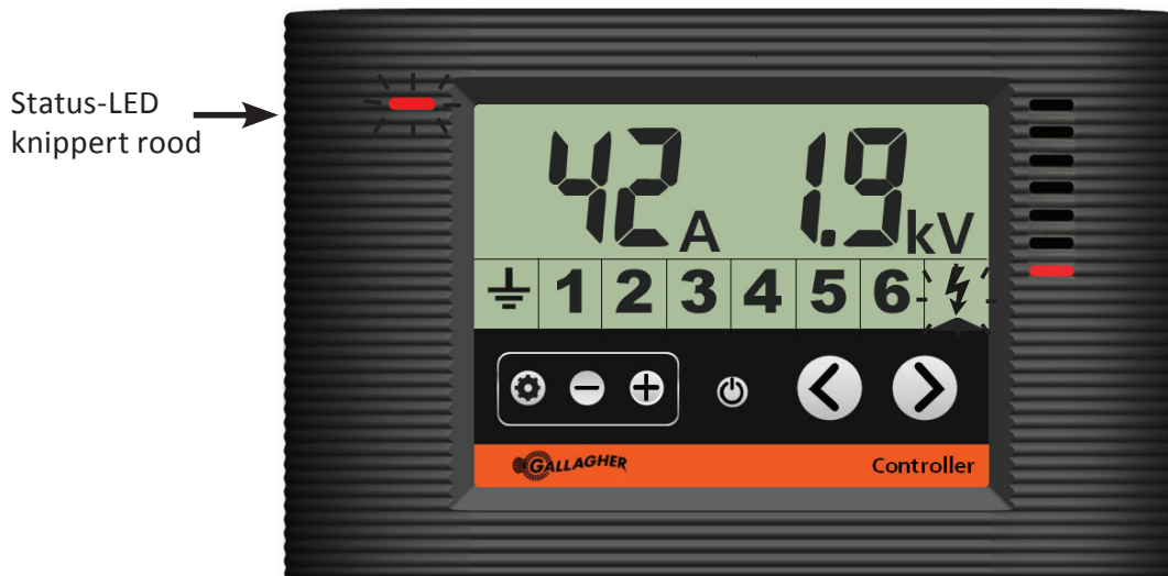
Bedieningspaneel toont het schrikdraadapparaat in stroomsterktealarm
