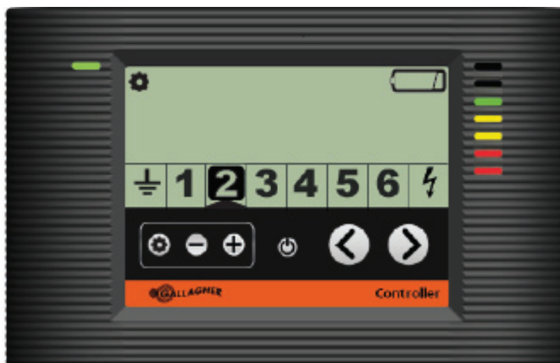
Controlador mostrando la zona 2 con batería baja
