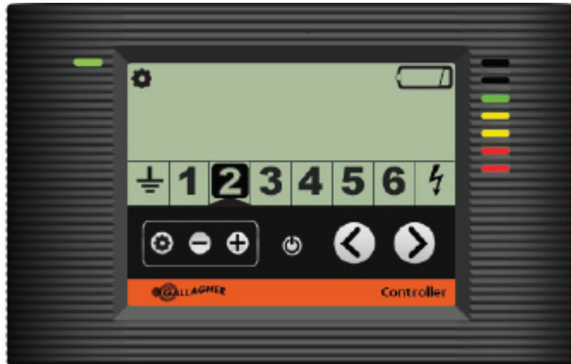
Styreenheden viser zone 2 med et lavt batteri
