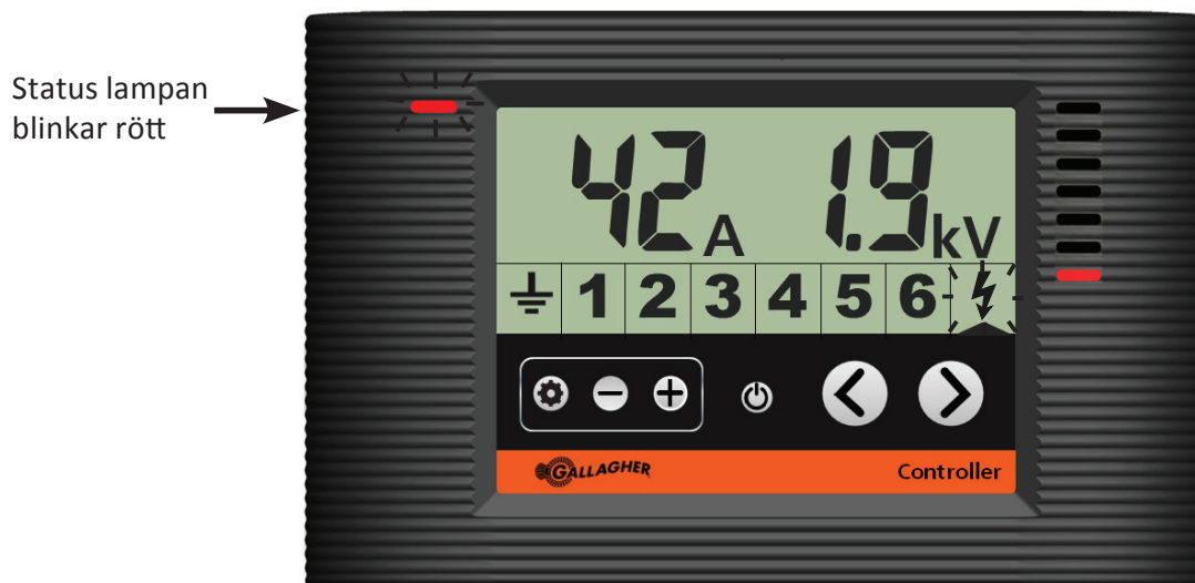
Kontrollen visar aggregat i ström larm
