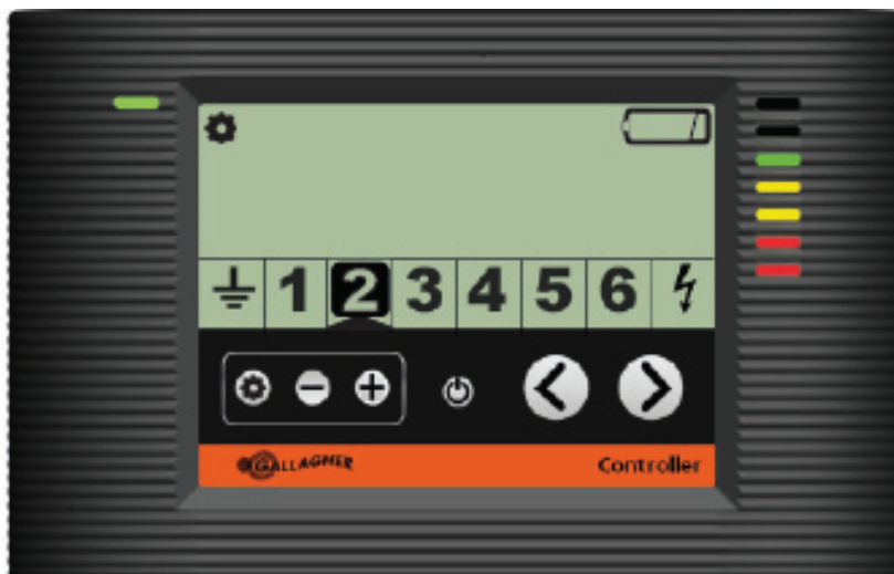
Kontroll visar zon 2 med en låg batterinivå
