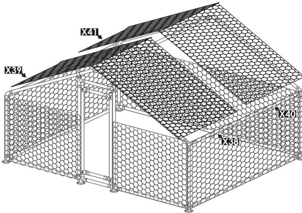
5. Rollen Sie das Drahtgitter **[F]** vom Befestigungspunkt **[X38]** bis zum Befestigungspunkt **[X39]** ab.
