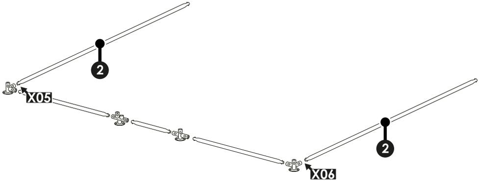
7. Stecken Sie je ein Rahmenteil B [2] an den Befestigungspunkten [X05] und [X06] in die noch offene, untere Öffnung der beiden Standfüße Ecke [C].
