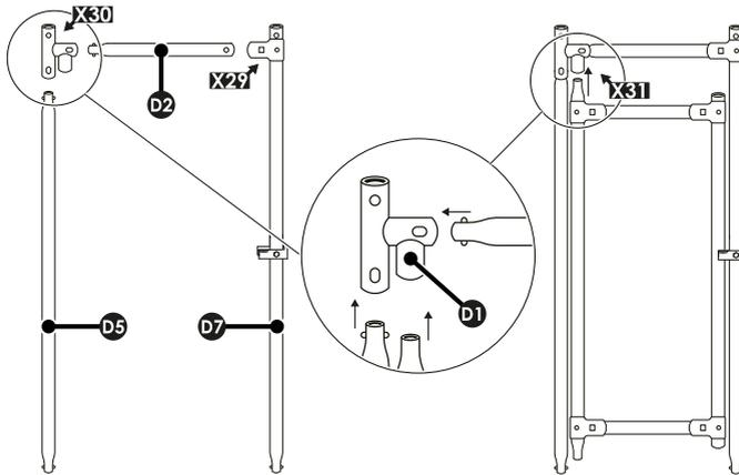
27. Stecken Sie den Türrahmen Links **[D5]** wie im Bild gezeigt von unten in das Türscharnier Oben **[D1]**.
