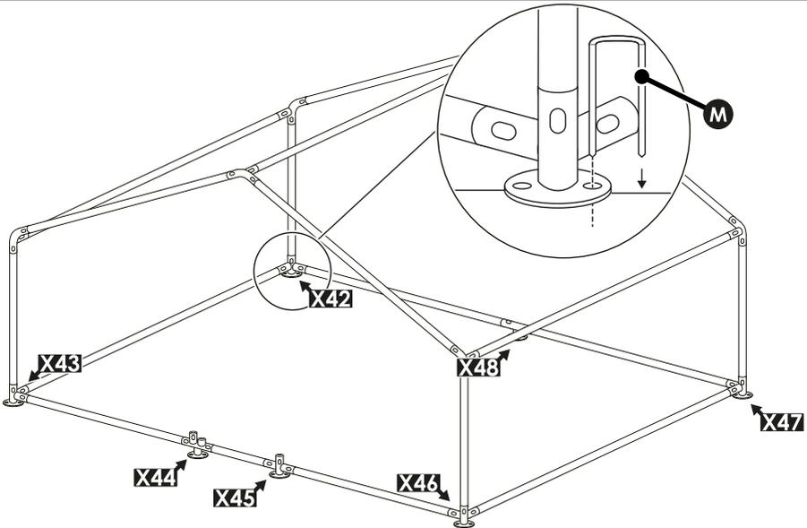
20. Befestigen Sie das Freilaufgehege mithilfe der 6 Erdnägeln [M] im Erdboden.
