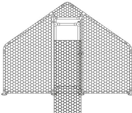
14. Verkleiden Sie die Tür des Geheges mit dem restlichen Drahtgitter **[F]** zwischen den Türstreben **[D3]**, **[D4]** und **[D6]**, wie im Bild gezeigt.
