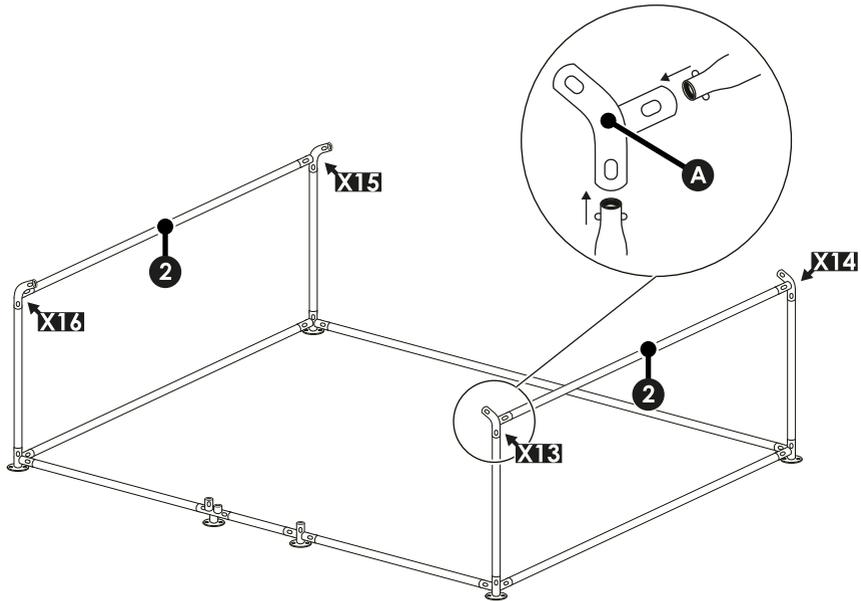
12. Stecken Sie am Befestigungspunkt **[X13]** einen Dachverbinder Ecke **[A]** auf das offene Ende des Rahmenteils C **[3]**, wie im Bild gezeigt.
