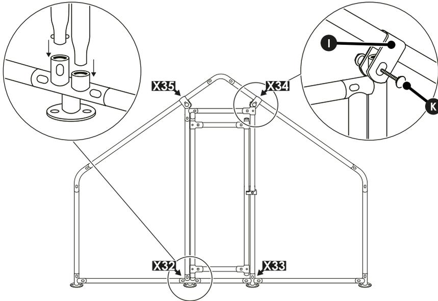
31. Stecken Sie das vormontierte Türgestell an den Befestigungspunkten **[X32]** - **[X33]** in das Türscharnier Unten **[P]** sowie den Standfuß Mitte **[D]**.
