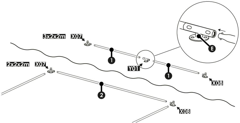
8. Stecken Sie an den Befestigungspunkten [X07] und [X08] je einen Standfuß Ecke [C] auf das Ende des Rahmenteils B [2], wie im Bild gezeigt.
