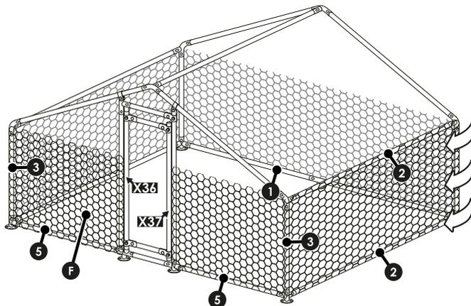
1. Wickeln Sie das Drahtgitter **[F]** der Länge nach vom Türrahmen Links **[D5]** am Befestigungspunkt **[X36]** um das Gestell des Freilaufgeheges bis zum Türrahmen Rechts **[D7]** am Befestigungspunkt **[X37]**.
