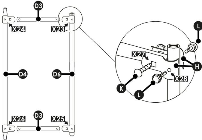
21. Verbinden Sie eine Tüstrebe **[D3]** am Befestigungspunkt **[X23]** mithilfe von 2 Türrahmenverbindern **[H]** mit der Tüstrebe Rechts **[D6]**.
