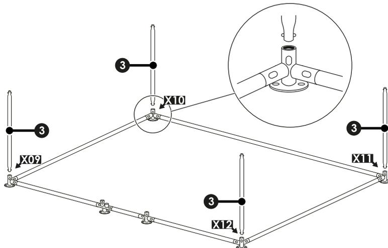
10. Stecken Sie ein Rahmenteil C [3] am Befestigungspunkt [X09] in die noch verbleibende Öffnung des Standfußes Ecke [C].
