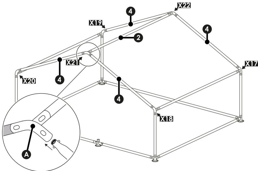
16. Stecken Sie ein Rahmenteil D **[4]** am Befestigungspunkt **[X17]** in das noch offene Ende des Dachverbinders Ecke **[A]**.
