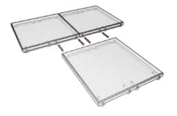
Die Terrasoft Systemstecker sind eine Einbauerleichterung mit Dübelcharakter und dienen der optimalen Lagesicherung.
