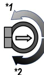
Die empfindlichste Einstellung (im Uhrzeigersinn nach rechts, bis Anschlag **\*2**) kann in manchen Fällen „zu spät“ schließen, also erst bei Einbruch der Nacht oder auch gar nicht, wenn z.B. Störlicht (Hof Lichter, Fabrikanlagen etc.) in der Nähe vorhanden ist.
