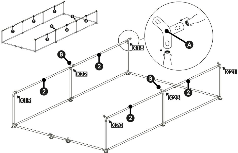
15. Stecken Sie am Befestigungspunkt **[X18]** einen Dachverbinder Ecke **[A]** auf das offene Ende des Rahmenteils C **[3]**, wie im Bild gezeigt.
