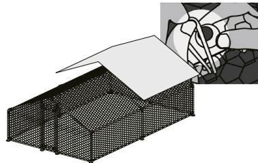
1. Lösen und entfernen Sie die Planenspanner (O) und die Dachplane (J).
