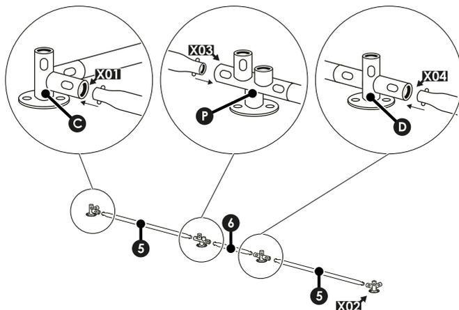
1. Stecken Sie ein Rahmenteil E [5] am Befestigungspunkt [X01] in die Öffnung eines Standfußes Ecke [C], wie im Bild gezeigt.
