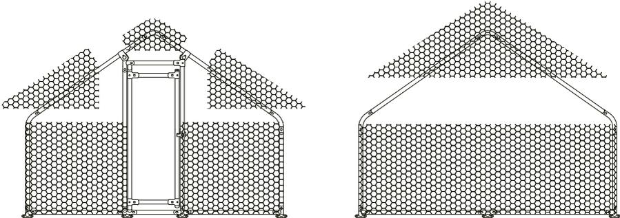
10. Verkleiden Sie die Giebelbereiche des Geheges ebenfalls mit dem Drahtgitter **[F]**, wie im Bild gezeigt.
