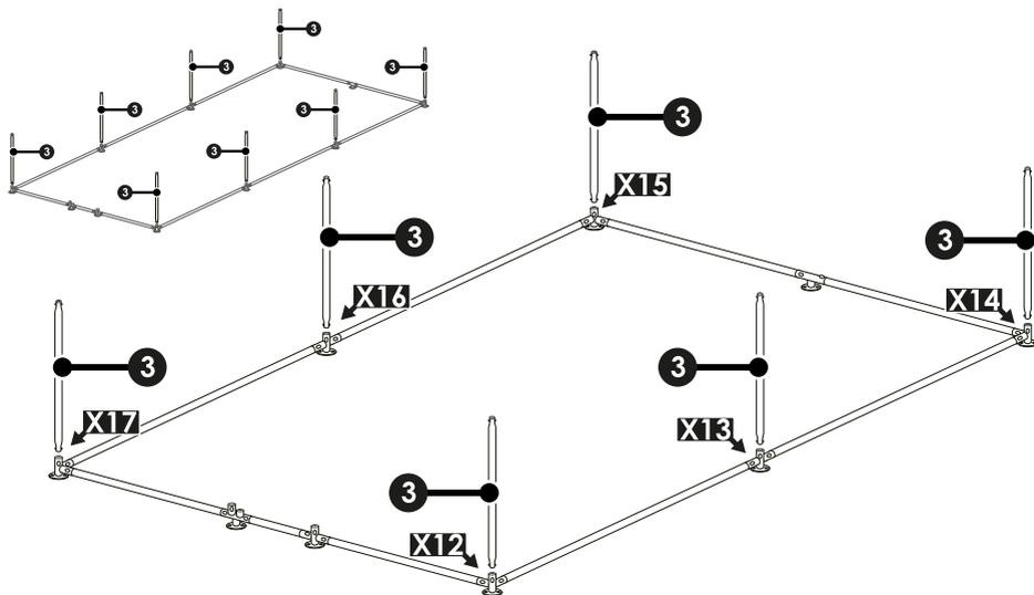
13. Stecken Sie ein Rahmenteil C **[3]** am Befestigungspunkt **[X12]** in die noch verbleibende Öffnung des Standfußes Ecke **[C]**.
