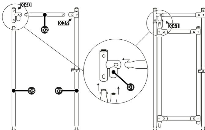
35. Stecken Sie den Türrahmen Links **[D5]** am Befestigungspunkt **[X40]** von unten in das Türscharnier Oben **[D1]**, wie im Bild gezeigt.
