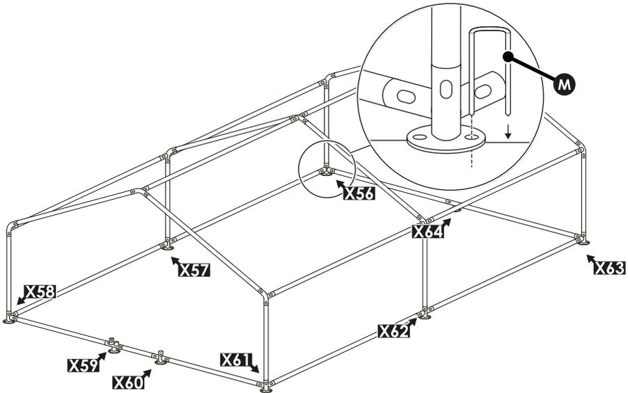
20. Befestigen Sie das Freilaufgehege mithilfe der 9 [nur 3x4x2 m] bzw. 11 [nur 3x6x2 m] Erdnägeln [M] im Erdboden.
