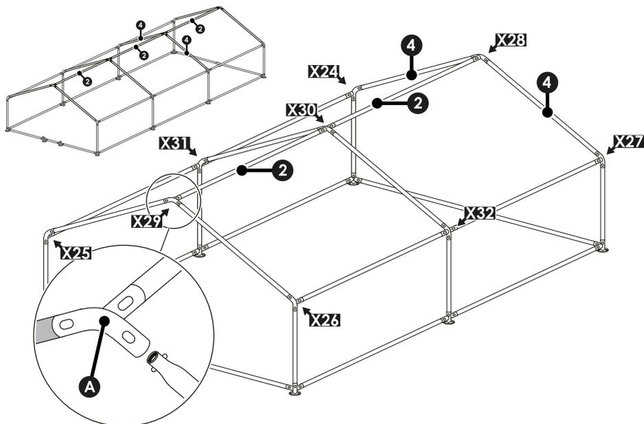
20. Stecken Sie je ein Rahmenteil D **[4]** am Befestigungspunkt **[X24]** und **[X27]** in das noch offene Ende des Dachverbinders Ecke **[A]**.
