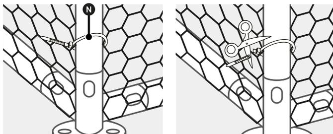
2. Befestigen Sie das Drahtgitter **[F]** mithilfe der Kabelbinder **[N]** mehrfach und in regelmäßigen Abständen am Gehegestell.
