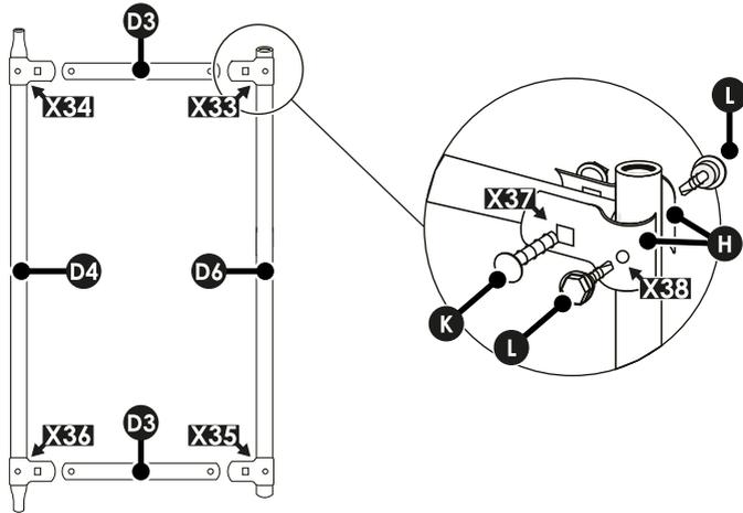
29. Verbinden Sie eine Tüstrebe **[D3]** am Befestigungspunkt **[X33]** mithilfe von 2 Türrahmenverbindern **[H]** mit der Tüstrebe Rechts **[D6]**.
