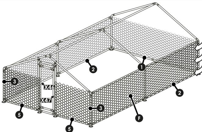
1. Wickeln Sie das Drahtgitter **[F]** der Länge nach vom Türrahmen Links **[D5]** am Befestigungspunkt **[X46]** um das Gestell des Freilaufgeheges bis zum Türrahmen Rechts **[D7]** am Befestigungspunkt **[X47]**.
