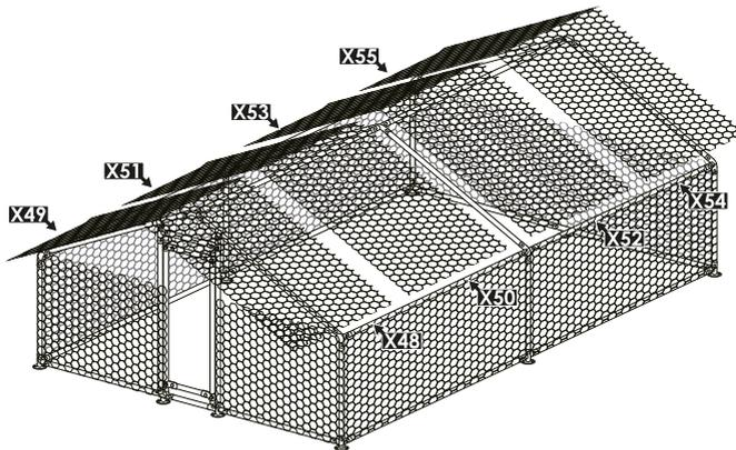
5. Rollen Sie das Drahtgitter **[F]** vom Befestigungspunkt **[X48]** bis zum Befestigungspunkt **[X49]** ab.
