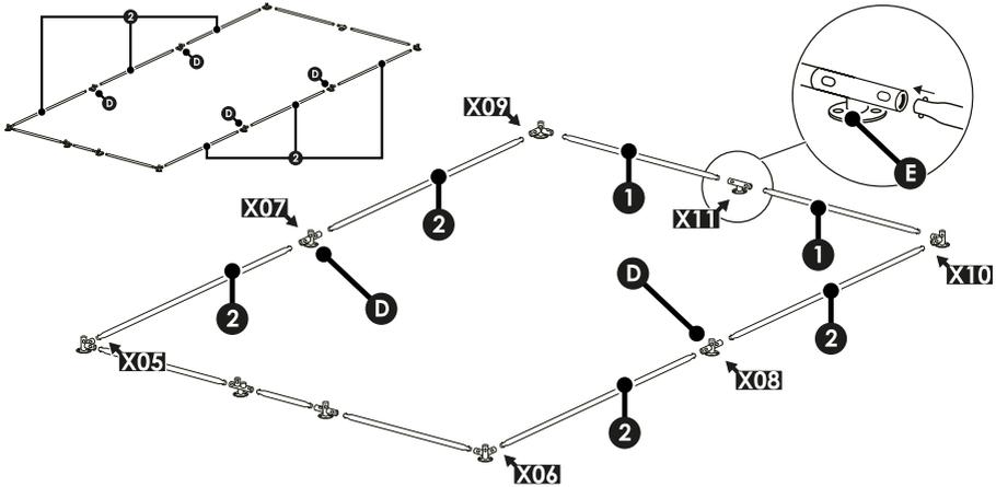
7. Stecken Sie je ein Rahmenteil B [2] an den Befestigungspunkten [X05] und [X06] in die noch offene, untere Öffnung der beiden Standfüße Ecke [C].
