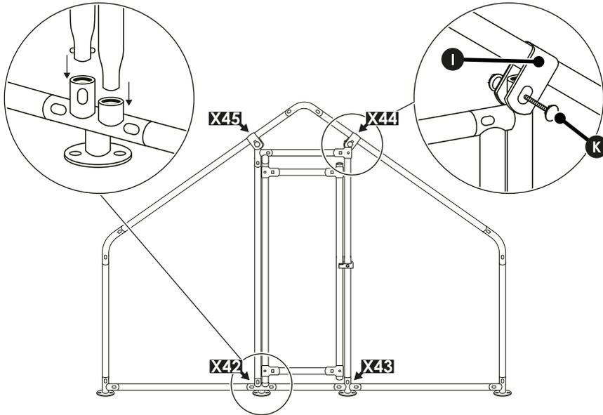
39. Stecken Sie das vormontierte Türgestell an den Befestigungspunkten **[X42]** - **[X43]** in das Türscharnier Unten **[P]** sowie den Standfuß Mitte **[D]**.
