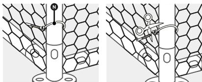
2. Durchtrennen Sie die Kabelbinder **(N)** mit einer Schere oder einem Seitenschneider.
