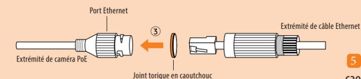
3 Appliquer le joint torique en caoutchouc au port Ethernet, puis brancher le câble Ethernet au port Ethernet
