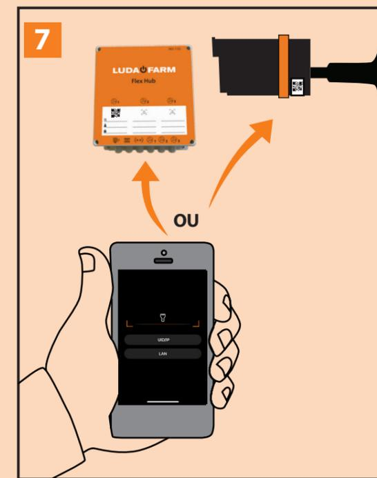
Scanner le code QR soit sur la caméra ou le Flex Hub. Les deux codes QR sur la caméra sont identiques et uniques pour chaque nouvelle caméra
